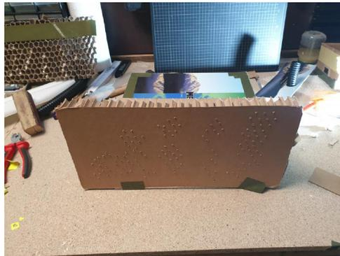
(3) Alle Sechsecke sind von außen, bis auf einige kleine Löcher in einzelnen Segmenten geschlossen.
