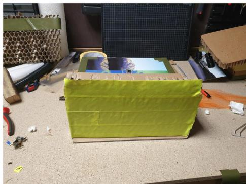
(5) Alle Sechsecke sind offen. es wird eine gelbgefärbte Folie vor die Segmente angeordnet
