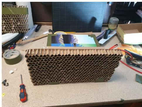
(4) Alle Sechsecke sind von innen, bis auf einige kleine Löcher in einzelnen Segmenten geschlossen.
