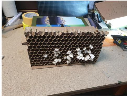
(2) Alle Sechsecke sind offen. Einzelne Segmente werden flächig verschlossen.
