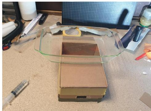
(2) Eine Glasplatte wird über die Öffnung gelegt. Auf der Glasplatte werden Wassertropfen verteilt.
