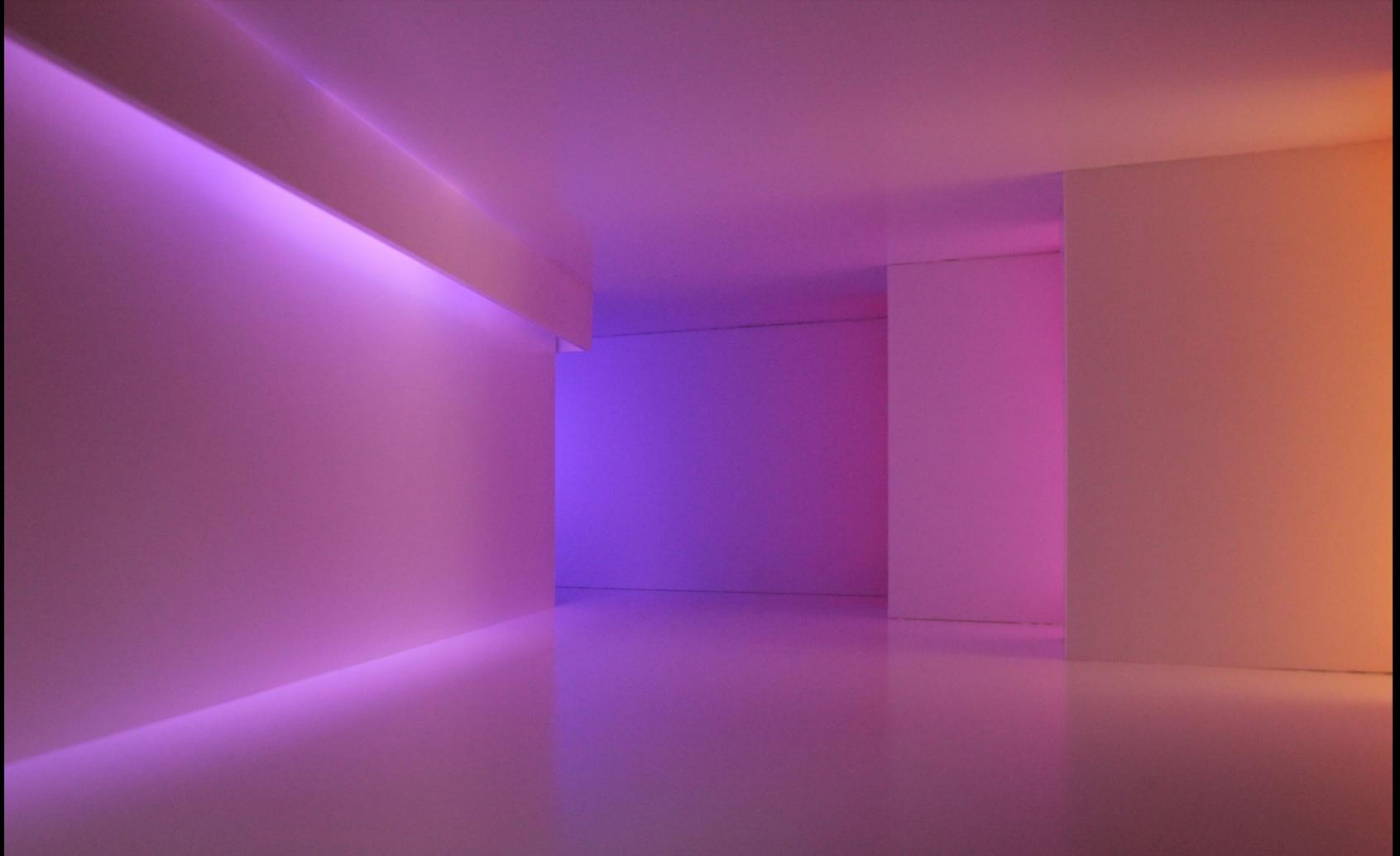
Durch das horizontale Verschieben einer Lichtquelle (vor der Öffnung hinten links) und dem damit verbundenen Schattenwurf entsteht "scheinbar" ein Knick in der ebenen Fläche.
