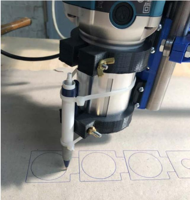
**Bei der Probefahrt sollten Sie nicht gleich die Fräse anwerfen. Ein umgebauter Kugelschreiber mit gefederter Spitze reicht als Werkzeug für erste Experimente.**
