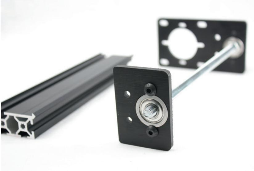
**Bild 5.6** Unten wird die Z-Spindel in Richtung der Drehachse nur lose geführt. So entstehen keine Spannungen.
