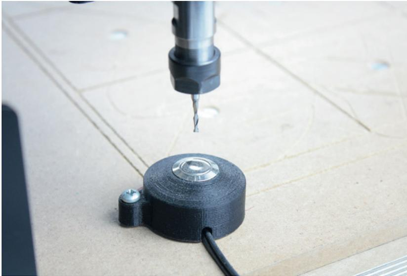
**Bild 2.36** Für unsere Maschine reicht ein kleiner Taster in einem 3D-Druck-Gehäuse.
