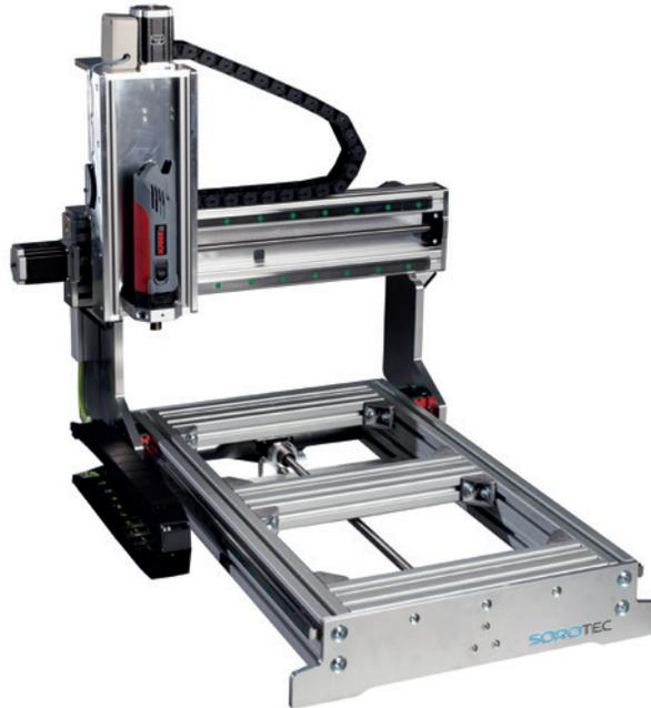
**Bild 2.28** Die Sorotec Basic Line besteht aus einem Mechanikbausatz, den man selbst mit Elektronik, Motoren usw. ergänzen muss (© Sorotec GmbH).
