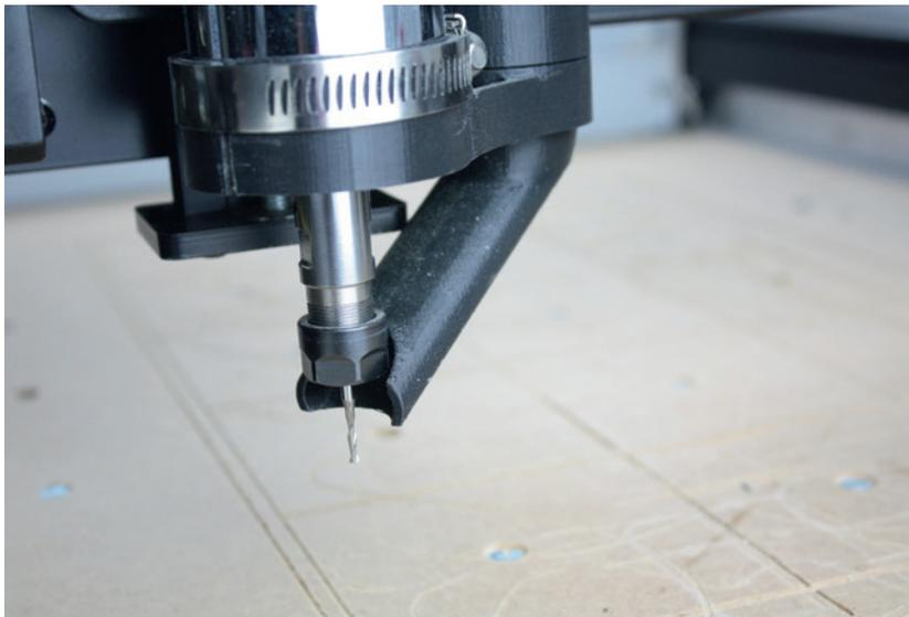
**Bild 2.33** Diese Späneabsaugung aus dem 3D-Drucker ist effizient und gibt guten Zugang zur Werkzeug-einspannung.
