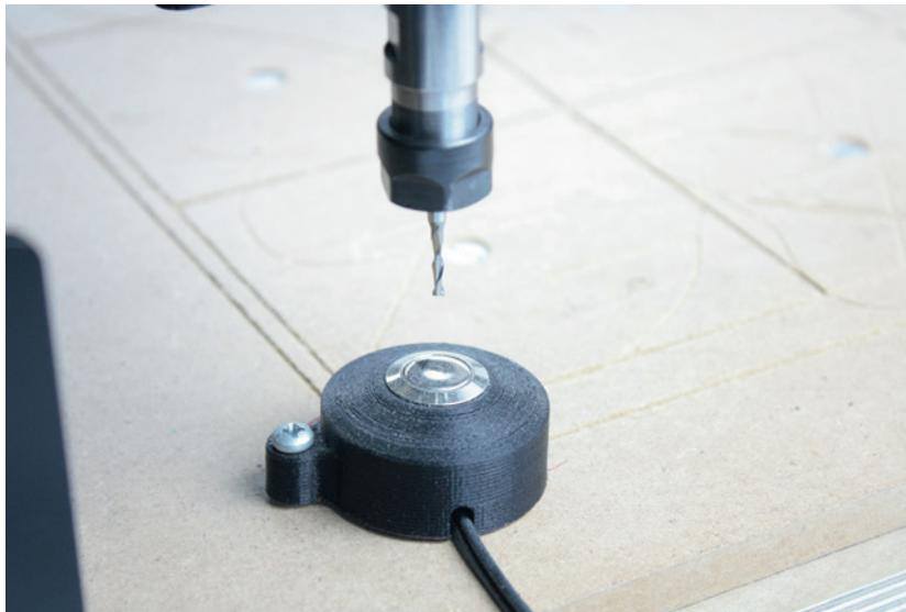
**Bild 9.5** Der Werkzeuglängentaster ermöglicht es, den Werkzeugnullpunkt einzumessen.
