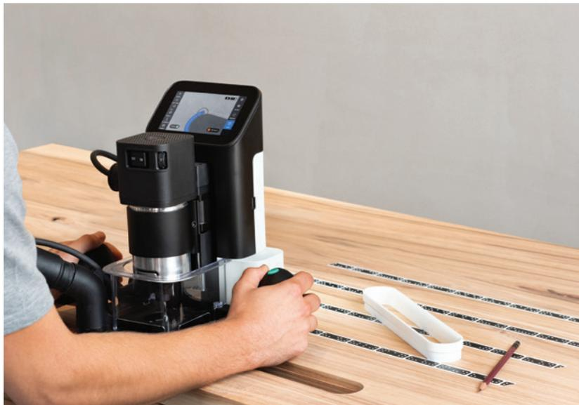
**Bild 2.27** Die Shaper Origin ist eine handgeführte CNC-Fräse. Die blaue Linie auf dem Bildschirm zeigt, wohin die Fräse bewegt werden muss. Das Klebeband ermöglicht der Maschine die Orientierung (© Shaper Tools, Inc.).
