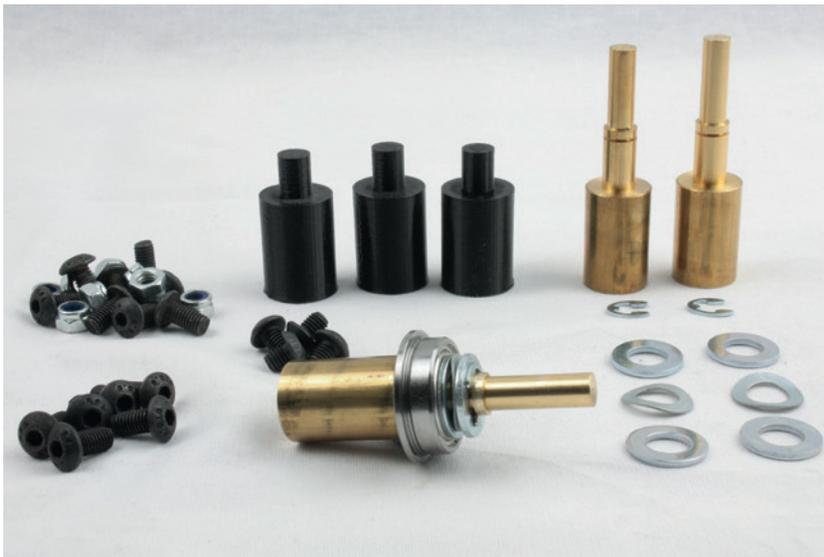
**Bild 5.16** Das Trapezgewinde-Set: Schrauben für die Lager (links hinten, vier kurze Schrauben für die Lager in den schmalen Y-Blechen), Hülsen (hinten) und sechs Schrauben M5x13 mm für die Trapezgewindemuttern. Die Scheiben und Sicherungsscheiben rechts vorn zeigen die Reihenfolge, in der sie auf der Hülse montiert werden.
