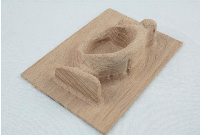
**Bild 2.19** Wenn du dieses Frästeil mit Bild 1.4 vergleichst, siehst du, dass die „Hinterseite“ des Objekts vom Fräser nicht erreicht werden konnte.
