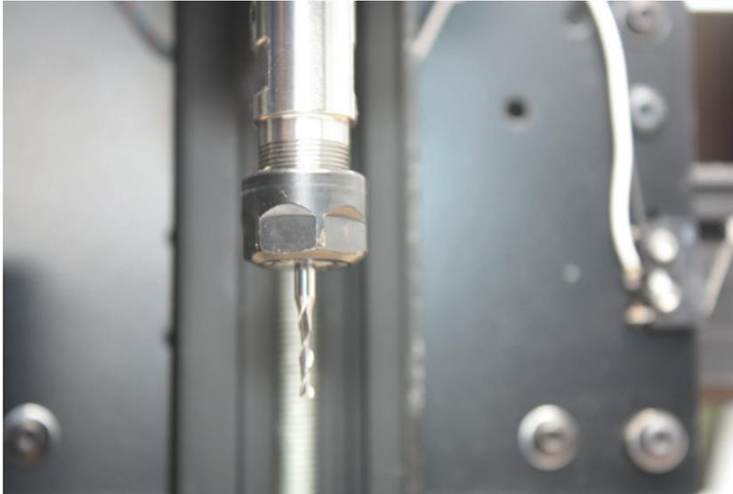
**Bild 2.13** Die Chinaspindel ist mit einer ER11-Werkzeugaufnahme ausgestattet.
