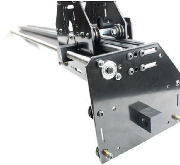
**Bild 5.17** Die erste Wange ist angebaut und die Spindel montiert. Hier siehst du, welche Schraublöcher für das Profil vorgesehen sind.
