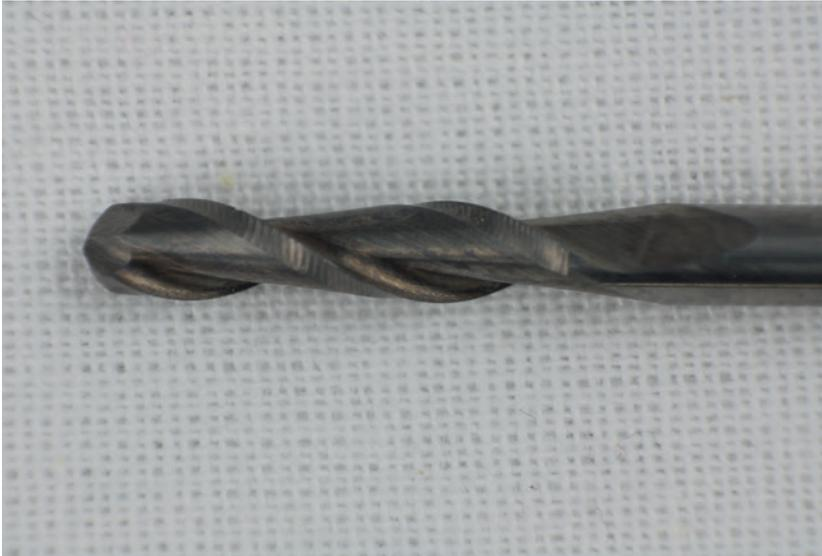
**Bild 3.4** Kugel- oder Radiusfräser haben meist nur eine runde Spitze. Das reicht für die Bearbeitung und bringt Stabilität.
