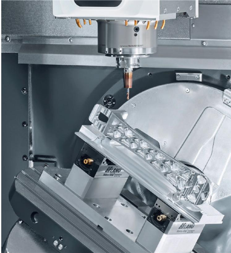
**Bild 2.21** Eine Fünfachsmaschine wie diese DMU 50 erreicht jeden Punkt eines Werkstücks (© DMG MORI).
