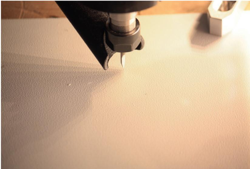
**Bild 9.2** Der Schattenwurf des Fräsers hilft dabei, die Höhe über dem Werkstück einzuschätzen.
