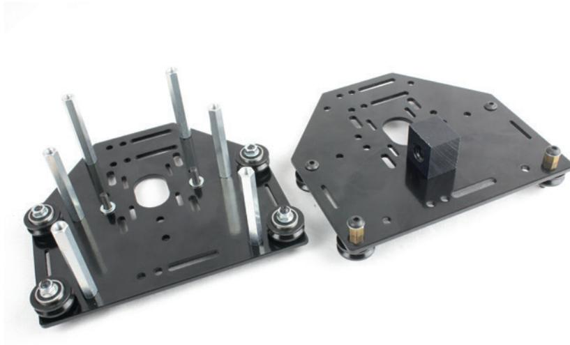
**Bild 5.13** Die hintere Platte des X-Schlittens: links für die Shapeoko-X mit Abstandhaltern (die Umlenkrollen fehlen noch, die Schrauben sind schon eingesetzt), rechts für die Shapeoko-T mit der Trapezgewindemutter
