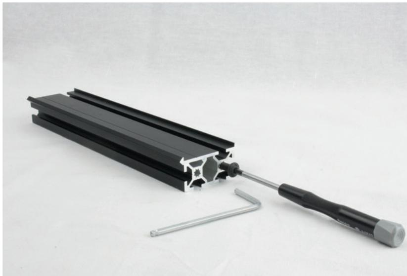
**Bild 5.8** Ein Inbusschlüssel mit Schraubendrehergriff hilft beim rechtwinkligen Ansetzen der Schrauben.
