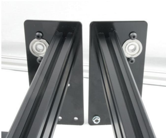
**Bild 5.20** Lager nach außen, Laufkanten zum Lager: So sitzen die vorderen Bleche richtig.
