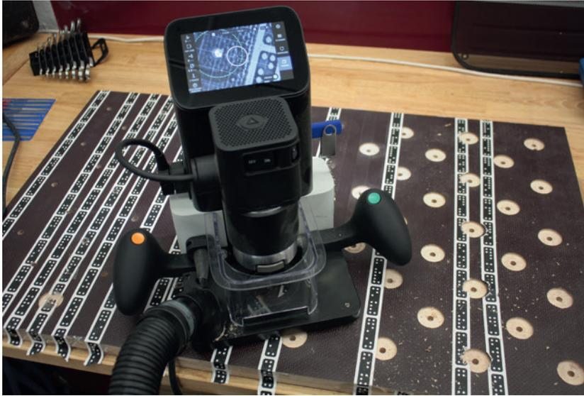
**Bild 5.29** Die Shaper Origin landete zum Test in meiner Werkstatt und wurde zum Fräsen der Arbeitsplatte eingesetzt.
