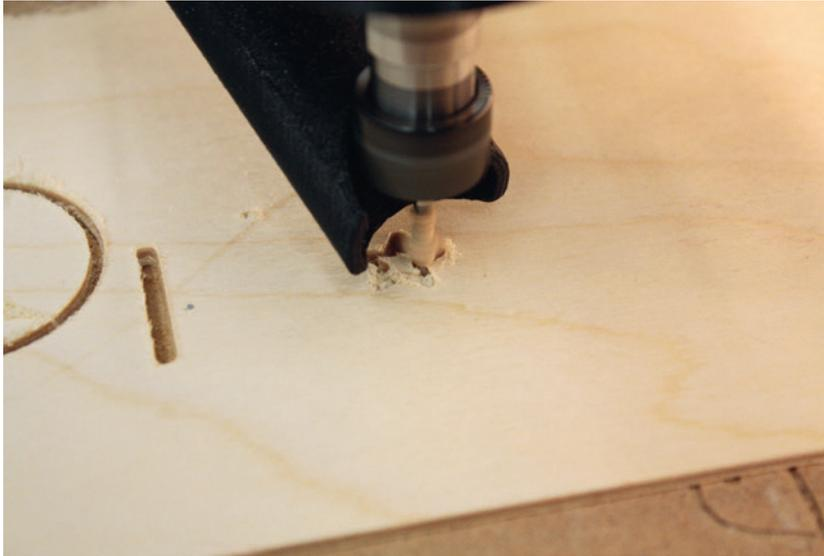
**Bild 7.18** Nicht nur die rotierende Spindel kann zur Gefahr werden, sondern auch lose Teile wie das Innere dieses Sternchens.
