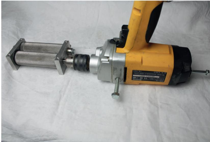
**Bild 8.39** Die Malzmühle bekommt einen Mörtelmixer-Antrieb. Die Schrauben zeigen die Verschraubungspunkte mit dem Gestell.
