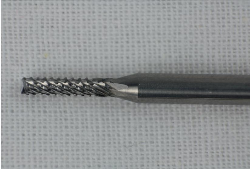
**Bild 3.8** Diamantverzahnte Fräser sind gute Allroundwerkzeuge vor allem bei harten Werkstoffen.
