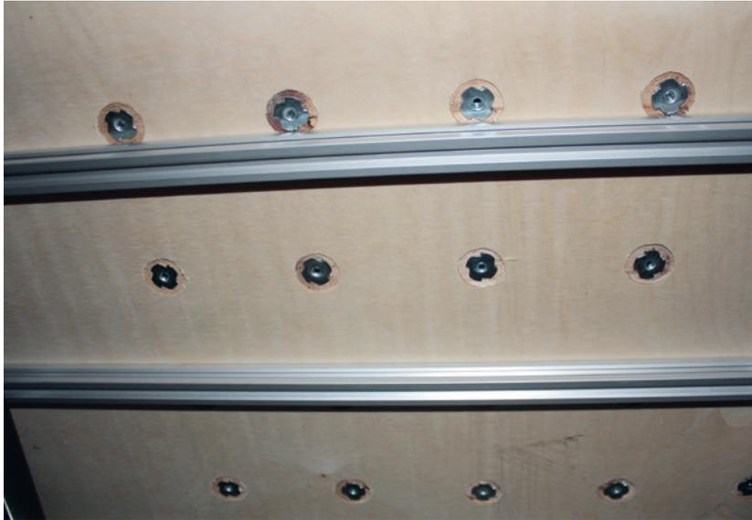
**Bild 4.6** Die Einschlagmuttern auf der Unterseite sitzen in gefrästen Vertiefungen.
