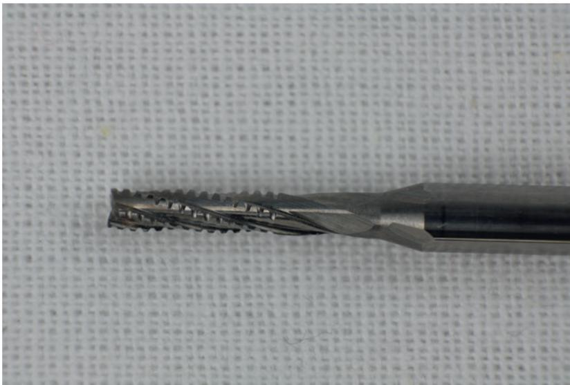
**Bild 3.9** Die Spanteilenuten an den Schneiden des Schruppfräses erzeugen kurze Späne, die sich gut abführen lassen.
