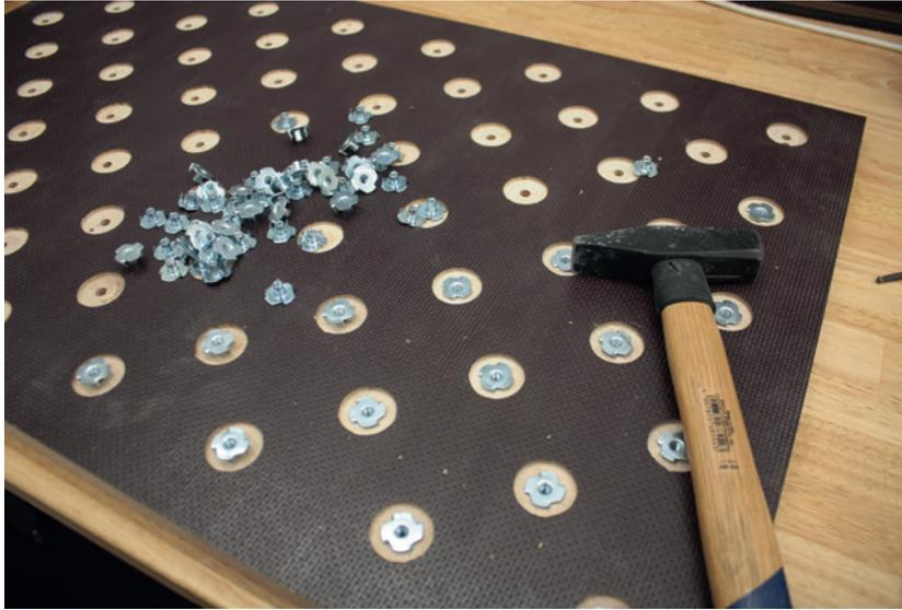
**Bild 5.37** Die Einschlagmuttern halten die auf der anderen Seite der Platte aufgespannten Werkstücke zuverlässig fest.
