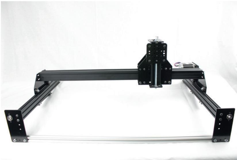
**Bild 5.22** Wenn das Portal eingeschoben wird, stellt sich der Rahmen von selbst auf die passende Breite ein.
