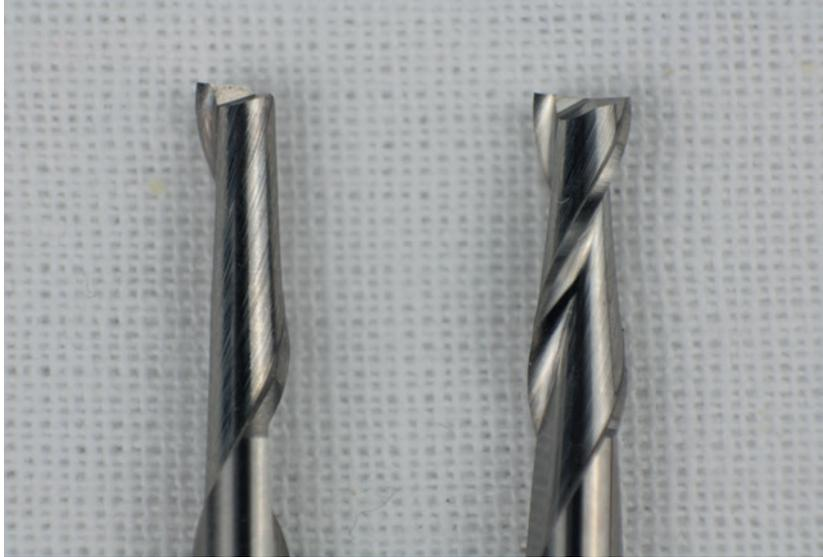
**Bild 3.7** Einschneider (links) und Zweischneider (rechts): Beim Einschneider ist deutlich mehr Spanraum vorhanden.
