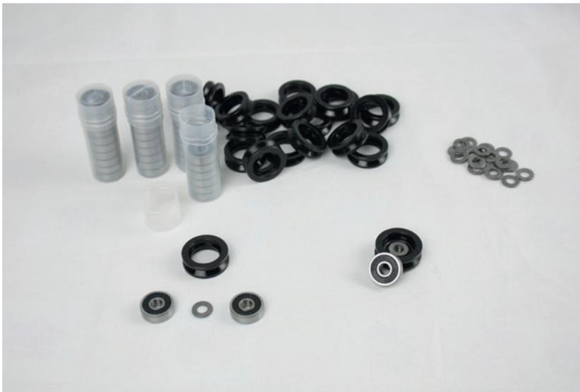
**Bild 5.3** 20 V-Rollen warten auf den Zusammenbau. Zwischen die Kugellager wird eine Präzisions-scheibe (1 mm) eingelegt.
