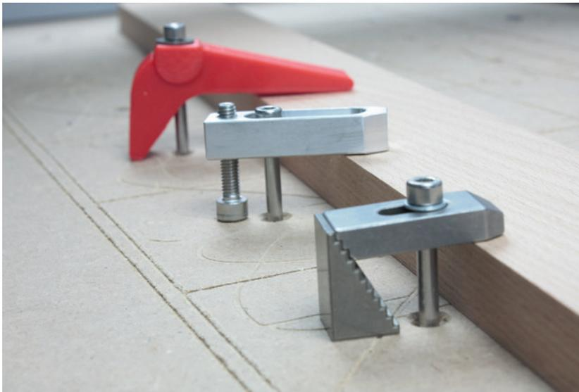
**Bild 2.32** Drei typische Spanneisen für Hobbymaschinen: vorne ein Spanneisen mit Treppenbock von Proxxon, in der Mitte eine Alupratze von eBay, hinten eine 3D-gedruckte Version aus Kunststoff
