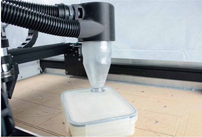
**Bild 9.13** Der Sprite-Flaschenzyklon funktioniert, läuft aber eher unter „Spielzeug“.
