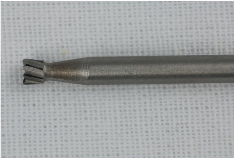
**Bild 3.5** Nutenfräser ermöglichen das Herstellen von Hinterschnitten.
