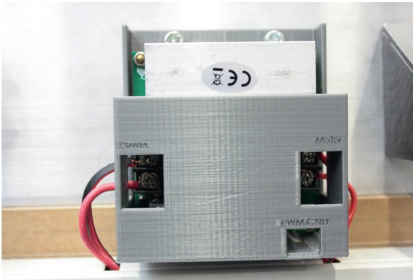
**Bild 6.5** Im 3D-gedruckten Gehäuse sitzt die Spindelsteuerung (links: Eingang, rechts: Ausgang, unten: PWM-Eingang von der Steuerung).
