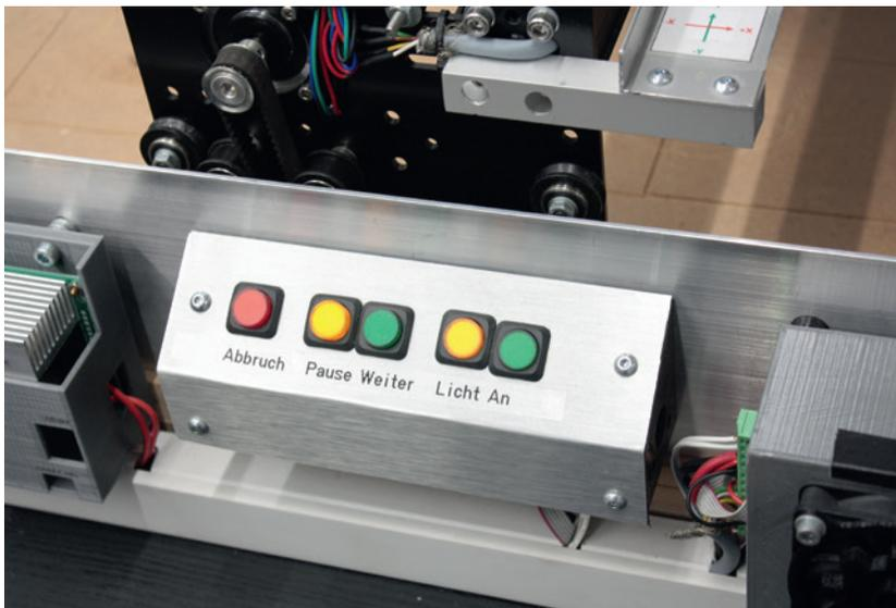
**Bild 6.10** Die wichtigsten Bedienfunktionen sind auf ein kleines Bedienpanel herausgeführt.
