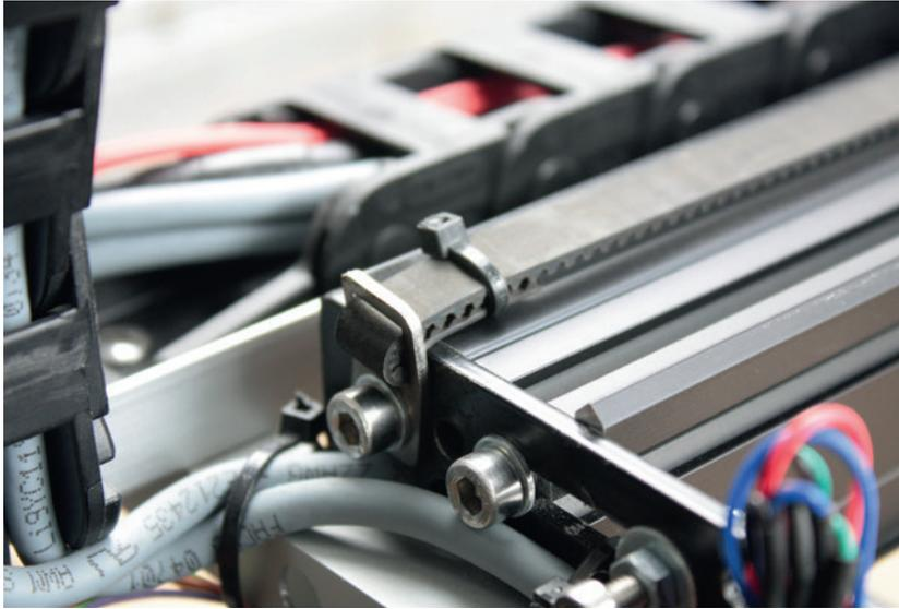
**Bild 5.27** Auf dem Portal wird der Festpunkt des Riemens durch ein Blech gebildet, das mit dem MakerSlide an der Portalwange verschraubt wird.
