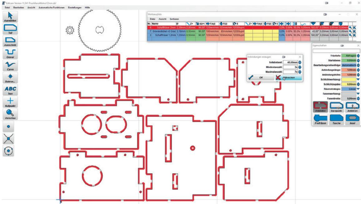
**Bild 8.17** Die automatisch erzeugten Anbindungen sind bei dem quadratischen Ausschnitt im Teil in der Mitte zu groß.
