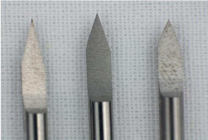
**Bild 3.6** Drei Gravierstichel mit 30, 40 und 50 Grad Spitzenwinkel (von links nach rechts). Je größer der Winkel, desto breiter und flacher die Gravur.
