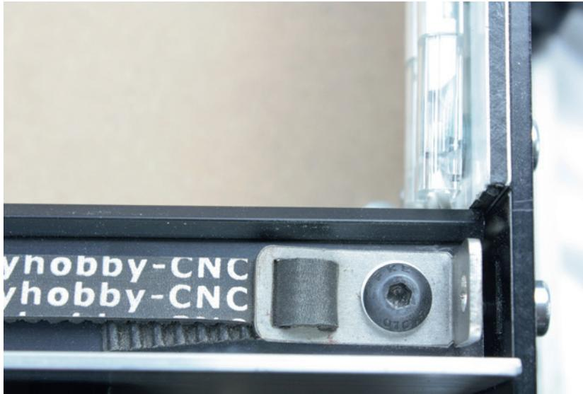
**Bild 5.26** Durch Verschieben dieses Blechs lässt sich der Riemen auf der Y-Achse spannen.
