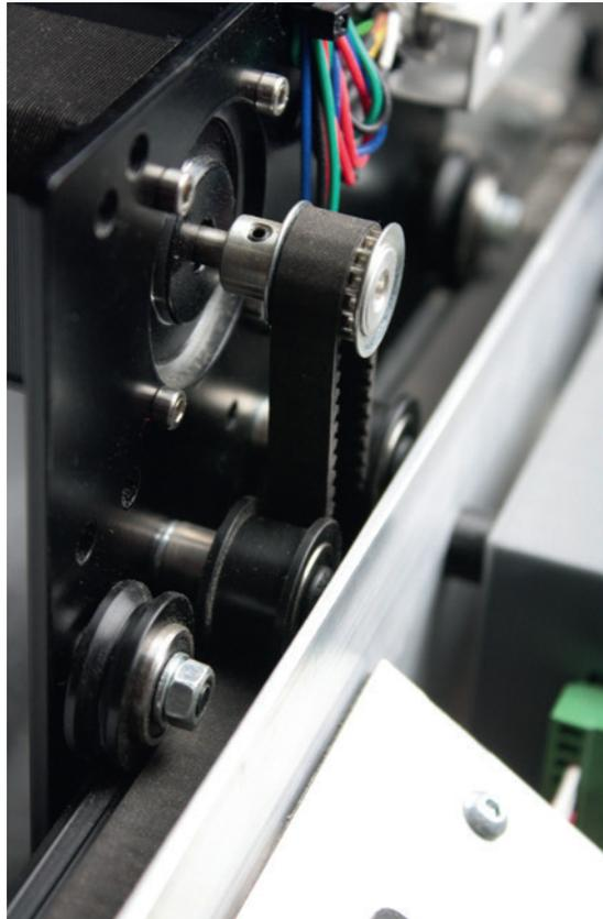
**Bild 5.12** Riemenführung mit Umlenkrollen an der Shapeoko-X (hier an einer der Portalwangen): Der Riemen liegt vorn und hinten im Bild flach auf dem Laufprofil und umschlingt den Motorpulley (alte Blechversion ohne Riemenspanner).
