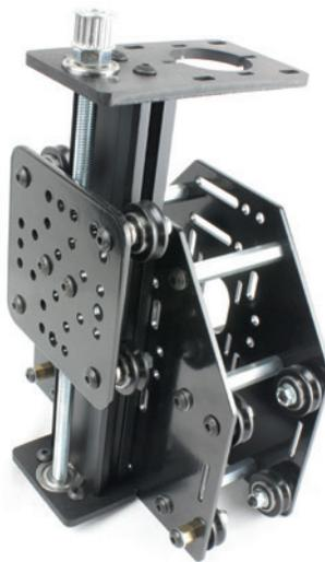
**Bild 5.14** Die Z-Achse und der X-Schlitten sind jetzt komplett montiert.
