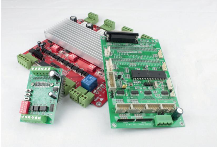
**Bild 10.3** Die vier Treiber der roten Platine benötigen wir bei der Shapeoko schon für drei Achsen. Eine „echte“ vierte Achse steuern wir mit dem Einzeltreiber links vorn.
