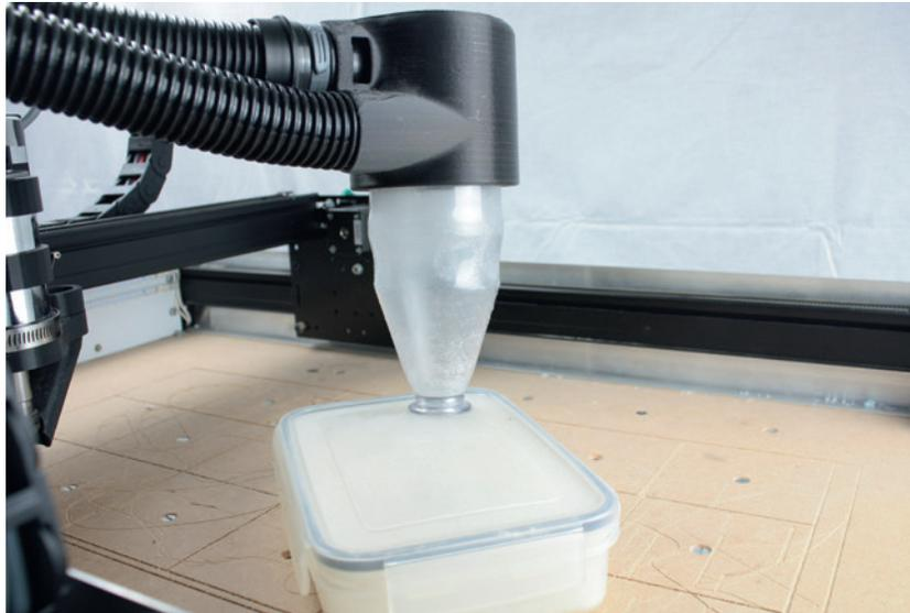
**Bild 2.34** Ein Zyklonfilter wie dieses Mini-Modell aus einem 3D-Druckteil und einer Limoflasche sammelt die groben Späne aus der Saugluft.
