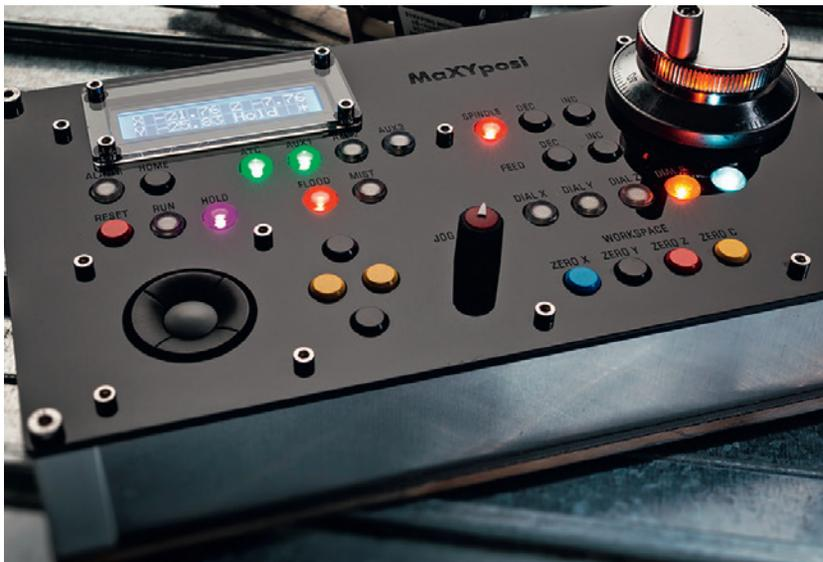
**Bild 10.2** Das MaXYpulti ist ein extrem komfortables Steuergerät für die MaXYposi-Steuerung (© Heise).
