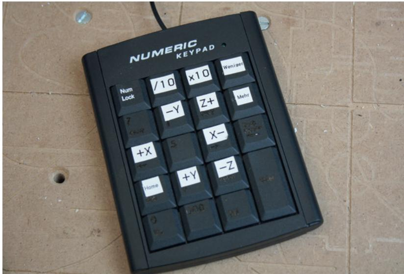
**Bild 7.7** Ein Keypad für 10 Euro und Beschriftungen auf den Tasten helfen beim Suchen des Werkstücknullpunkts.
