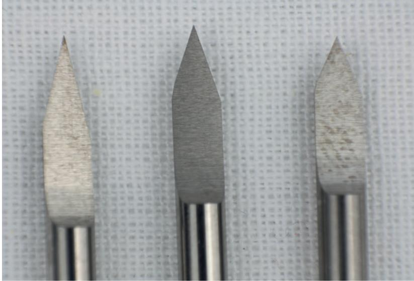
**Bild 8.6** Gravierstichel haben eine einfache Geometrie und unterscheiden sich vor allem im Winkel und in der Breite der Spitze.
