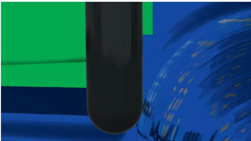
**Bild 3.3** Der Radiusfräser berührt das Werkstück immer an einem definierten Punkt und ist deshalb besonders zum 3D-Fräsen geeignet.
