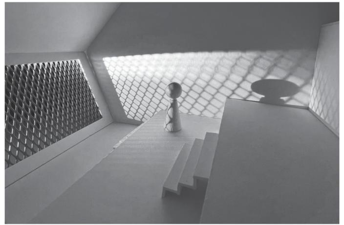
Eine weitere Idee war der Einsatz verschiedener Gitterstrukturen, durch die das Licht spannende Muster an die Wände projiziert.
