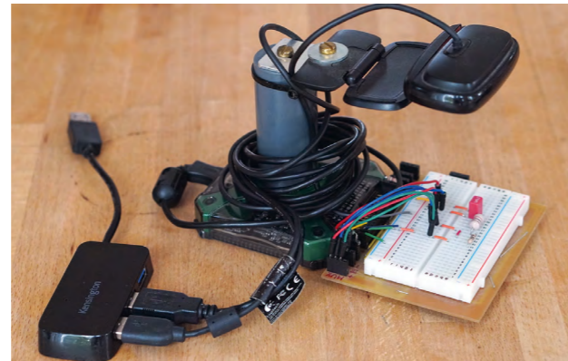
Abb. 1: Aufbau des Systems mit Analog Discovery, Adapterplatine mit Steckbrett und Webcam.
