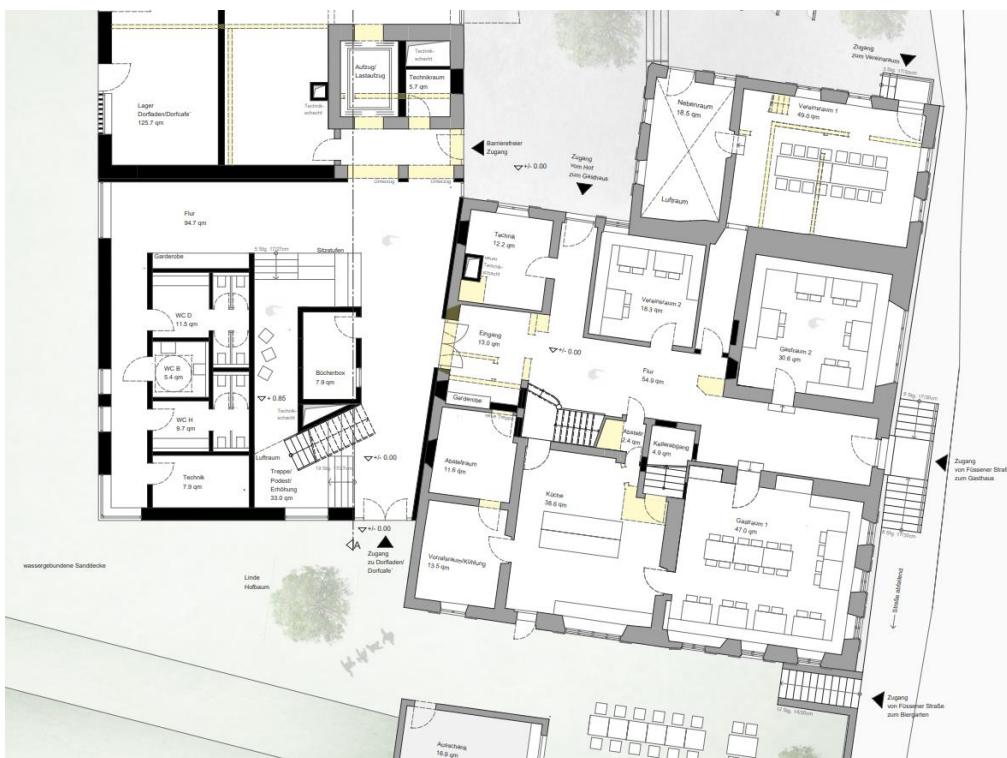
Abbildung 50: neuer Grundriss Erdgeschoss Gasthaus
