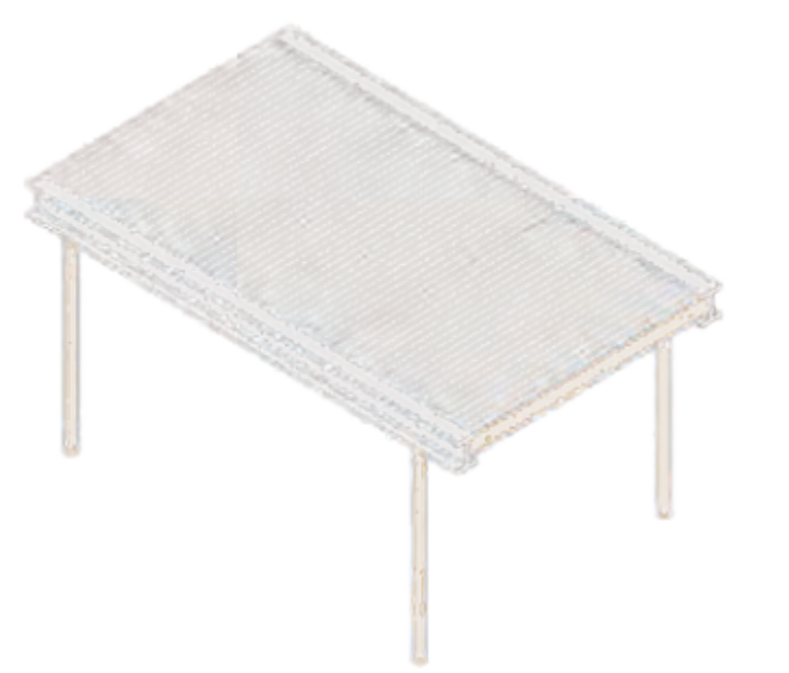
Stahlträger mit eingeschobener Brettstapeldecke
