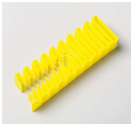
Bei diesem Teststück hat der Drucker hinten rechts gar kein Filament vor Bewegungen eingezogen und vorne links 9,5 mm<sup>3</sup>. Optimal ist wenig Einzug, aber auch keine Fäden – hier also 7 mm<sup>3</sup>.
